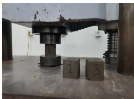
Gambar 3.33 Pengujian kuat tekan mortar
