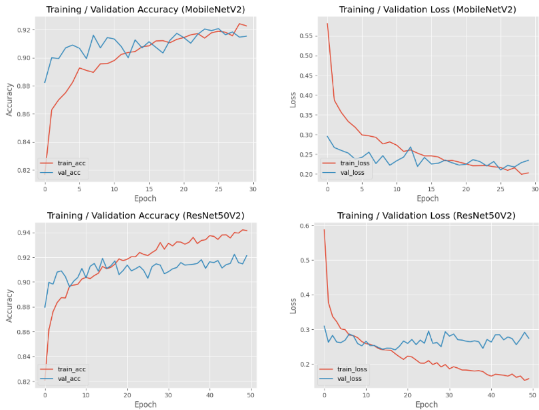
Gambar 4.7 Grafik Perbandingan Akurasi dan Loss pada Training/Validation (intel)
