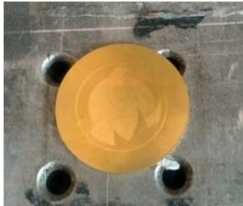
Gambar 5.21 Percobaan ukiran lasercut pada kuningan ( sumber: Olahan Pribadi)
