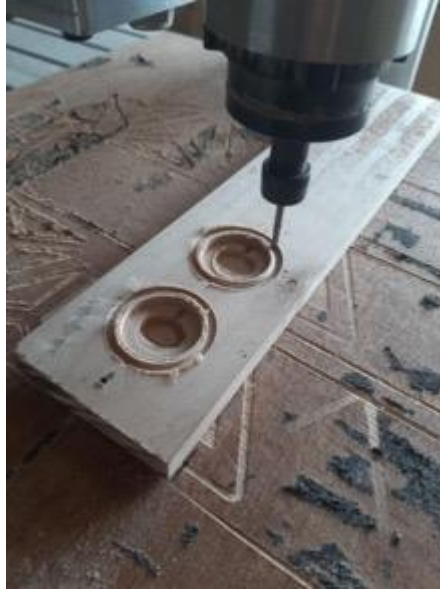
Gambar 5.12 Proses pemotongan CNC ( sumber: Olahan Pribadi)
