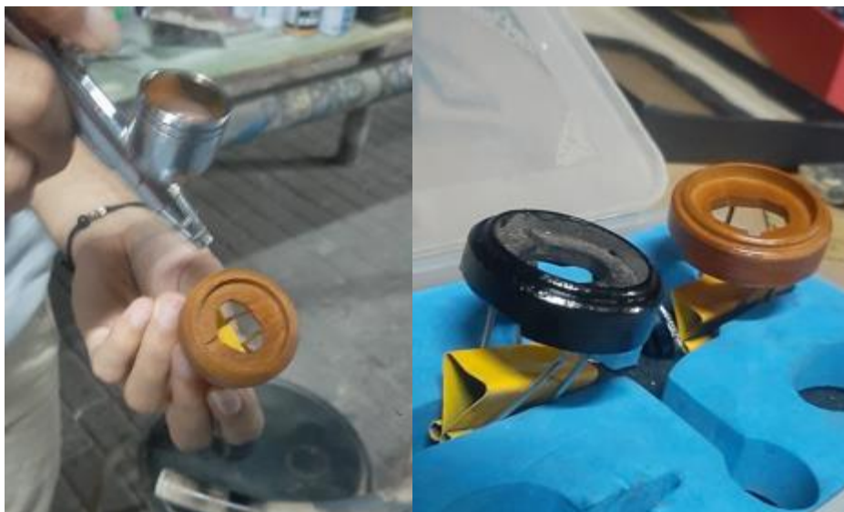
Gambar 5.16 proses pernis dan pengeringan ( sumber: Olahan Pribadi)
