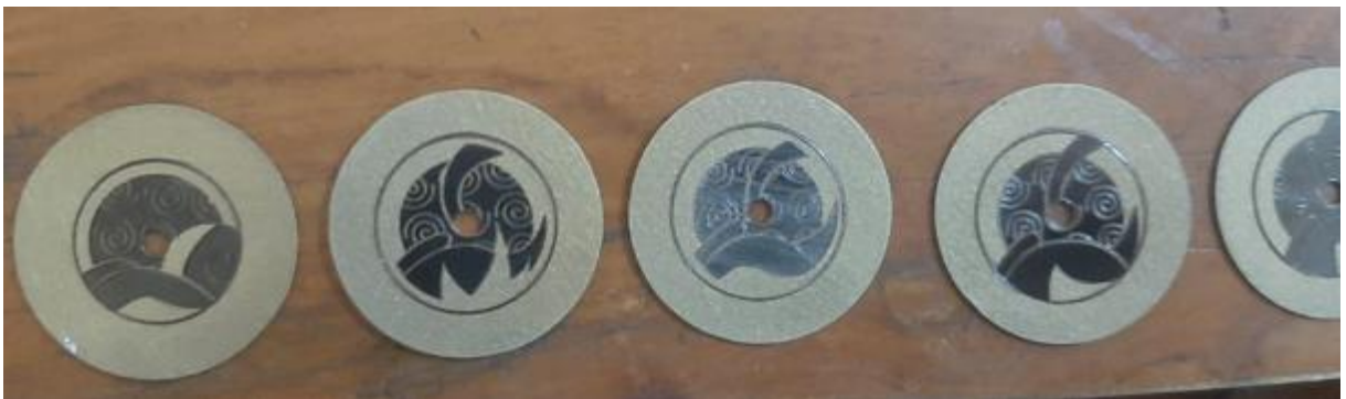
Gambar 5.22 Hasil grafir pada stainless steel ( sumber: Olahan Pribadi)
