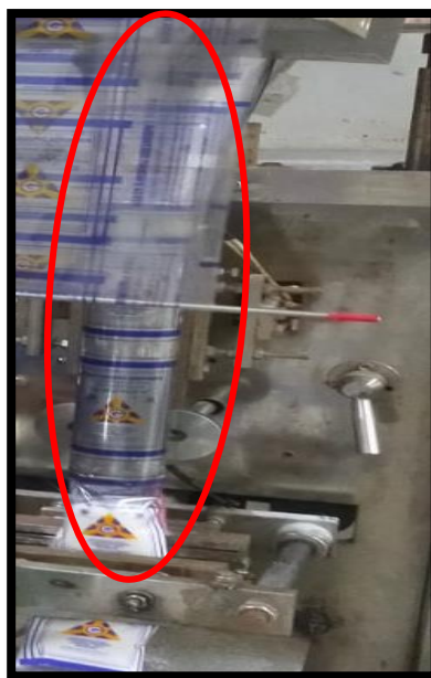
Gambar 5.36 Corong Pengisi Garam ke Plastik Pada Mesin Packaging Secara garis besar, bahan material mesin packaging yang bersentuhan langsung dengan
