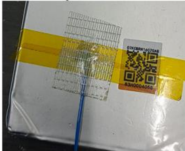
Gambar 4. 1 Pemasangan Thermocouple pada Baterai
