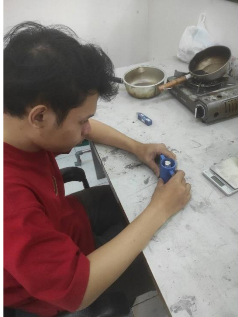
(b) Pemasangan cetakan PCM ke holder
