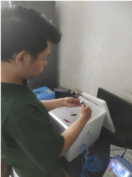
(a) Pemasangan thermocouple dan kabel baterai tester ke modul baterai.
