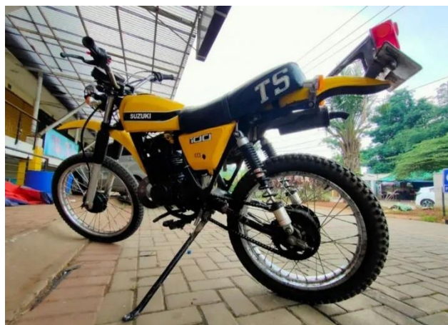
Gambar 2. 6 Suspensi Dual Spring pada Sepeda Motor Trail
