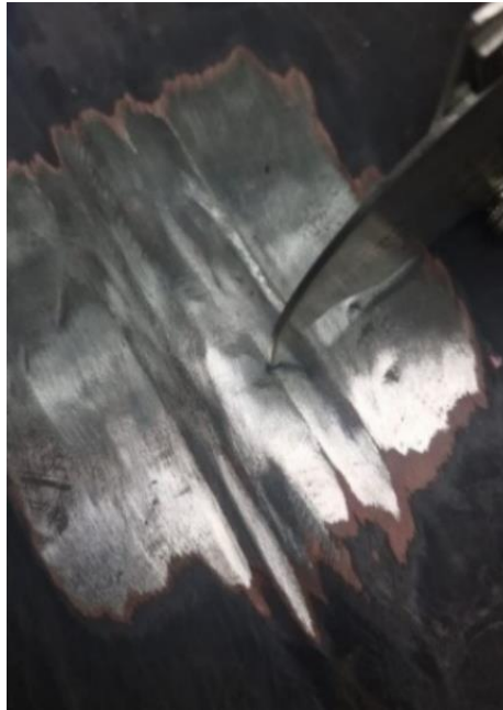
Gambar 4. 1 Contoh Cacat Las pada Submersible Vehicle
