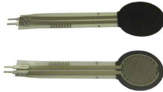
**Gambar 3.4.** Sensor Tekanan FSR [18]
