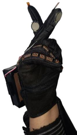
**Gambar 4.1.** Peletakan Sensor FSR
