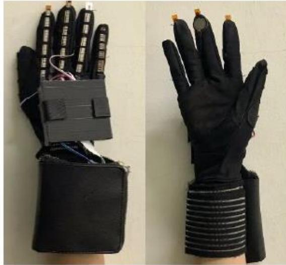
**Gambar 2.4.** Desain Pemasangan Sensor Flex dengan Dijahit [7]
