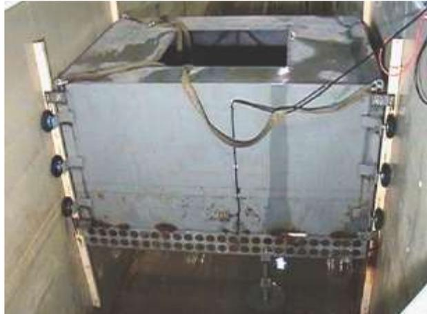
**Gambar 2.23** *Semi-immersed breakwater* dengan pelat berpori [32]
