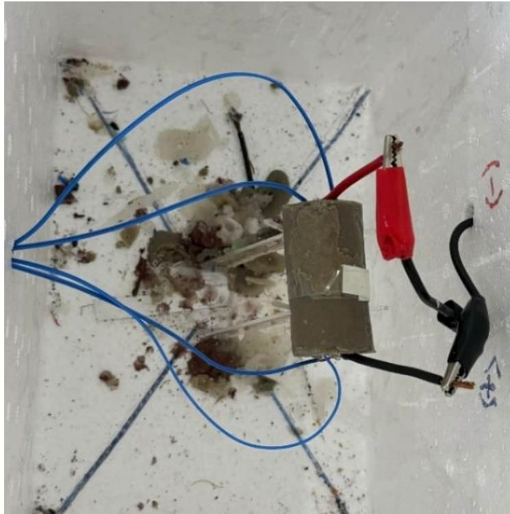
Gambar 3.7 Pemasangan Thermocouple dan Kabel Battery Tester pada Baterai
