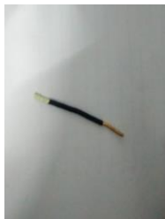
Elektroda emas termodifikasi Au/Nafion/ \text{WO}_3
