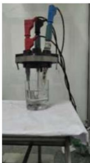
Pengujian oksalat secara elektrokimia dengan sistem tiga elektroda
