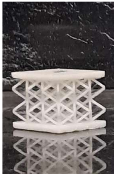
Gambar 3.6 Hasil 3D Printing dengan Sudut 0 Derajat terhadap Sumbu-X
