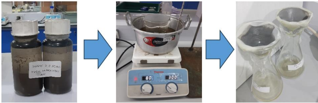
Gambar 4.1 Skema Preparasi Abu Layang
