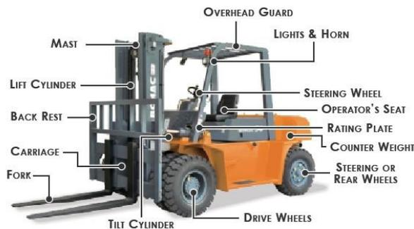
**Gambar 4.72** Komponen utama pada *forklift*
