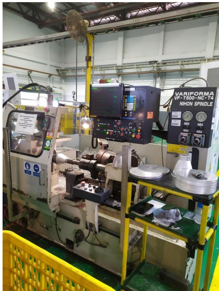
**Gambar 4.77** Mesin *Metal Spinning* di *Spinning Room*
