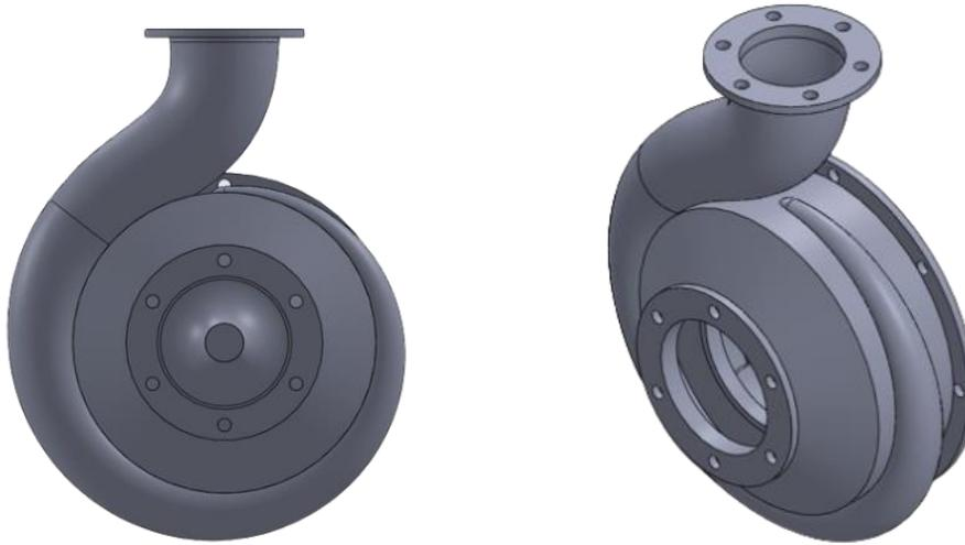
**Gambar 3.3** *Assembly Volute dan Impeller*
