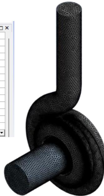
**Gambar 3.7** *Set Up Meshing* dan *Meshing* Keseluruhan Geometri Fluida *Volute* dan *Impeller*
