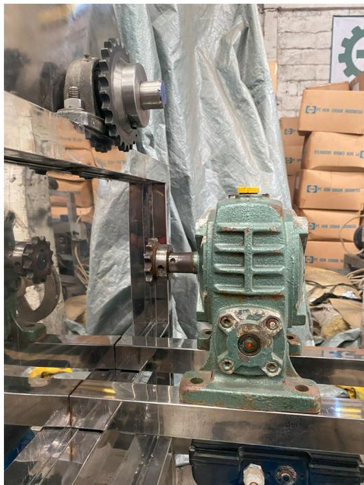
**Gambar 3. 13** Proses perbaikan adanya misalignment pada mesin mixer marinasi
