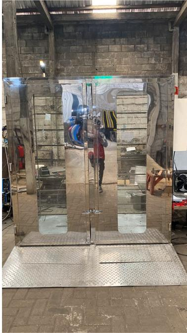
**Gambar 3. 12** Tampak depan mesin oven 2 pintu setengah jadi
