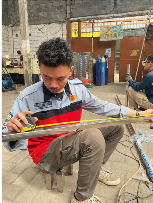
**Gambar 3. 34** Proses pengukuran hollow stainless steel oleh mahasiswa untuk kerangka ekstraktor
