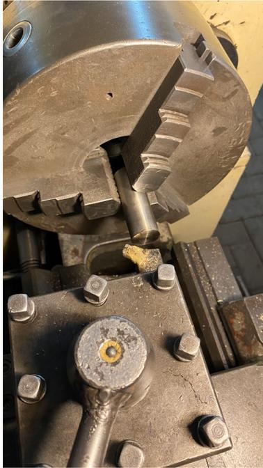
**Gambar 3. 38** Persiapan proses *turning* ass pengaduk pada mesin bubut
