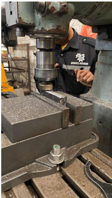
**Gambar 3. 7** Proses *spot facing* pada mesin frais
