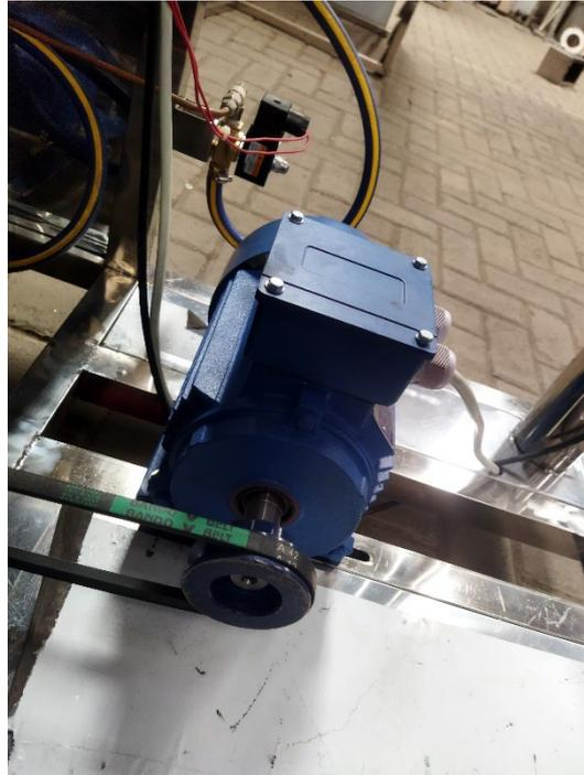
**Gambar 3. 27** Pemasangan v-belt pada motor
