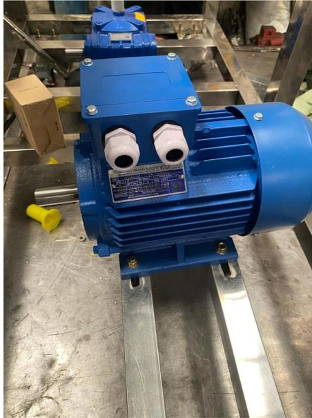
**Gambar 3. 25** Proses pemasangan motor dan gearbox pada alat
