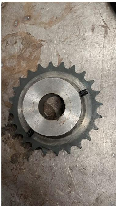
**Gambar 3. 11** Pembuatan *borg* pada sprocket mesin *mixer* marinasi
