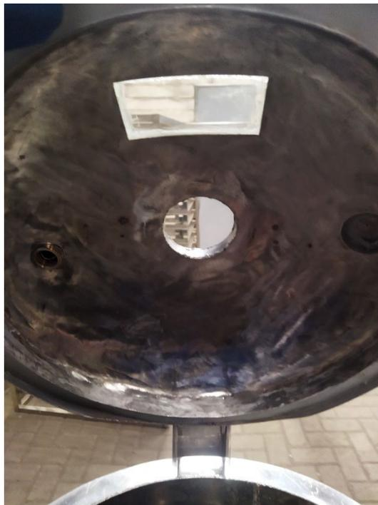
**Gambar 3. 43** Proses perakitan tutup tabung
