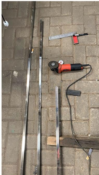
**Gambar 3. 35** Proses pemotongan hollow dengan mata gerinda *cutting*
