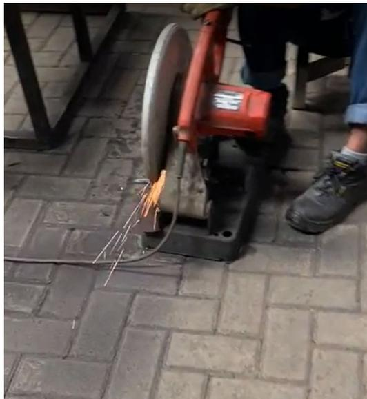
**Gambar 3. 37** Proses pemotongan ass round bar dengan gerinda duduk
