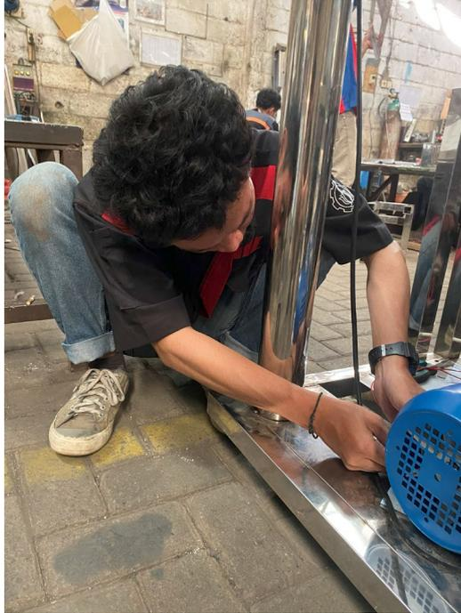
**Gambar 3. 42** Proses perakitan oleh mahasiswa pada komponen elemen mesin di alat ekstraktor
