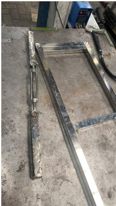
**Gambar 3. 3** Kerangka *cover* mesin pasteurisasi modern yang sudah dilakukan penyambungan
