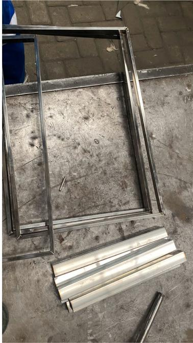
**Gambar 3. 8** Kerangka luar pada loyang oven
