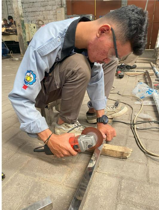
**Gambar 3. 36** Proses pemotongan *hollow stainless square* yang dilakukan oleh mahasiswa
