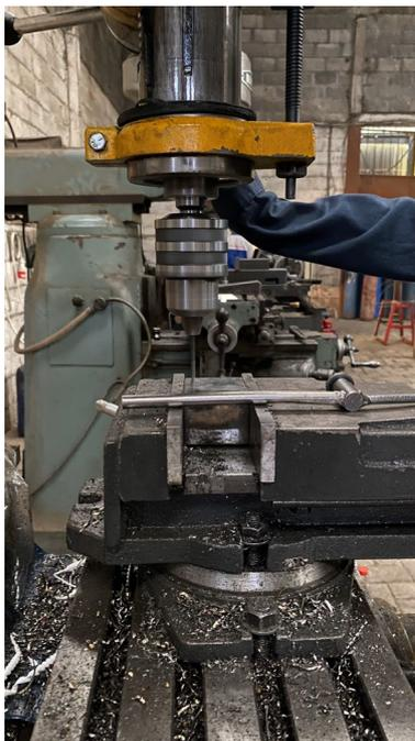
**Gambar 3. 39** Pengoperasian mesin bor oleh mahasiswa untuk membuat lubang dengan ukuran mata bor M6
