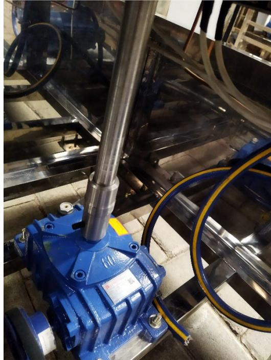
**Gambar 3. 24** Proses pemasangan gearbox pada alat
