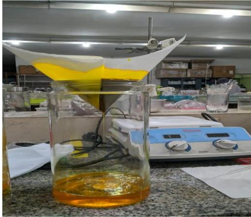
Gambar 3. 3 Proses maserasi (pembuatan ekstraksi) dengan pelarut *diklorometana*
