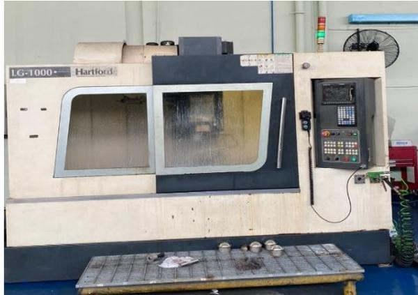
**Gambar 2. 13** Mesin CNC Milling
