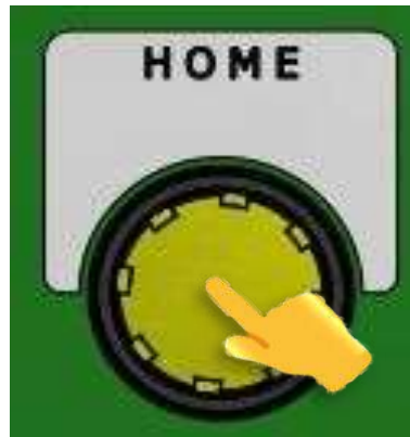
Gambar 4.20 Tekan dan tahan selama 3 detik tombol HOME untuk Homepos (sumber : PT. Matahari Megah)
