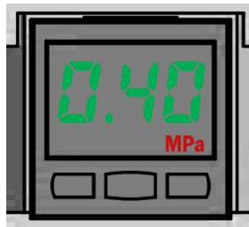
Gambar 4.15 Pressure Gauge disetting pada 0,4Mpa (sumber : PT. Matahari Megah)
