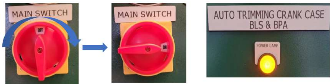
Gambar 4.17 Putar Main Switch ke ON, dan pastikan lampu Power Lamp menyala. (sumber : PT. Matahari Megah)
