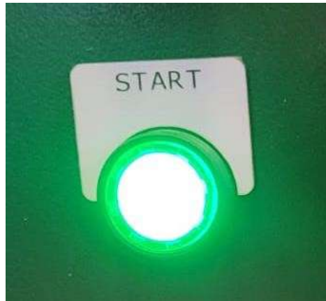
Gambar 4.24 Mode Auto , lampu ditombol START menyala (sumber : PT. Matahari Megah)
