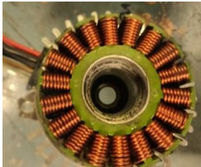
Gambar 2. 14 Belitan pada stator (Usman & Rajpurohit, 2020)
