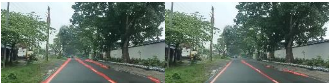
Gambar 4.10 Hasil Deteksi Lajur oleh SegNet-ConvLSTM (kiri) dan UNet-ConvLSTM (kanan) pada Kondisi Cuaca Hujan dan Jalan Lurus.
