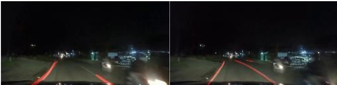
Gambar 4.15 Hasil Deteksi Lajur oleh SegNet-ConvLSTM (kiri) dan UNet-ConvLSTM (kanan) pada Kondisi Malam Hari dan Jalan Belok Kiri
