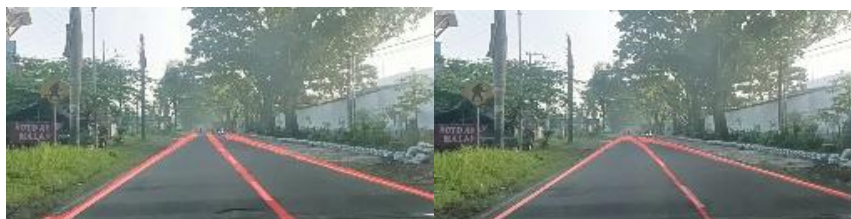
Gambar 4.6 Hasil Deteksi Lajur oleh SegNet-ConvLSTM (kiri) dan UNet-ConvLSTM (kanan) pada Kondisi Jalan Lurus dan Cuaca Cerah.
