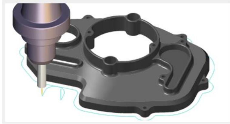
**Gambar 4. 17** *Toolpath Contour* pada *Mastercam X5*
