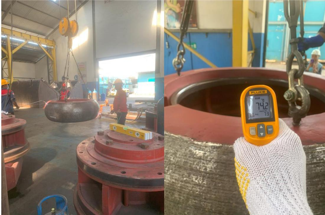
Pemantauan *Assembly* Grinding Roll dan Housing dengan Metode *Pre-Heating* hingga mencapai suhu Pemuaiian lalu *Normalizing*
