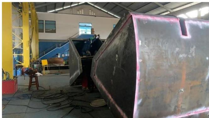
**Gambar 4. 16** Hasil Penetrant Test pada Grab Bucket
