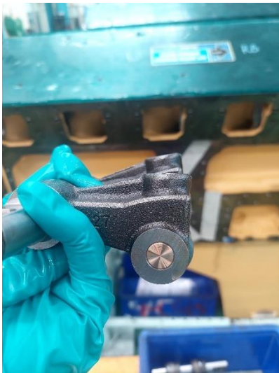
Pemasangan Camfollower kebagian camshaft
