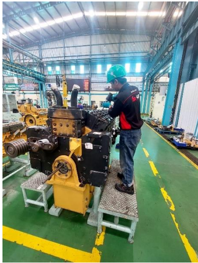
Pemasangan baut pada Cylinder head dan melakukan prepare sebelum melakukan pemasangan Clinder Head
