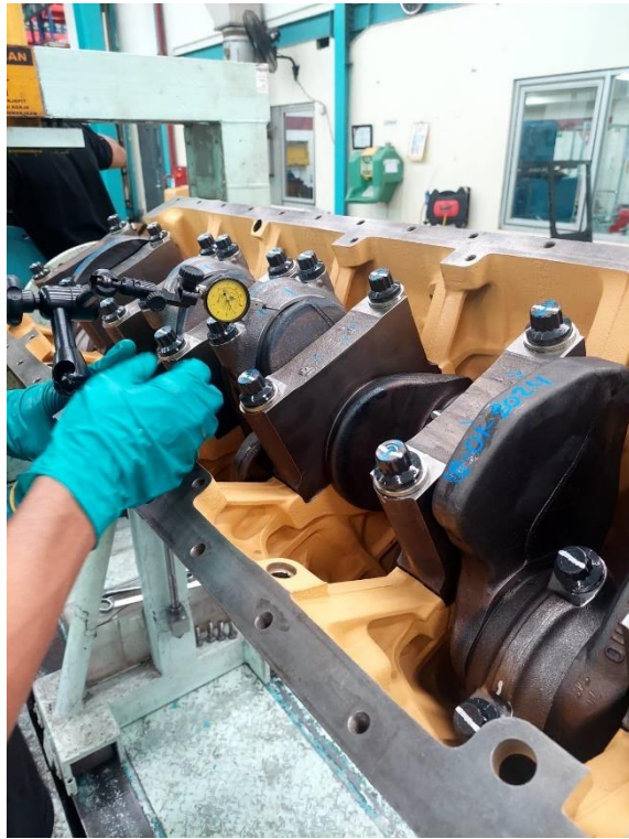
Pengukuran endplay pada Crankshaft
