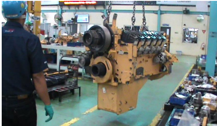
Gambar 4.92 Pemindahan Engine Dengan Overhead Crane (Sumber : Dokumen Pribadi, 2024)
