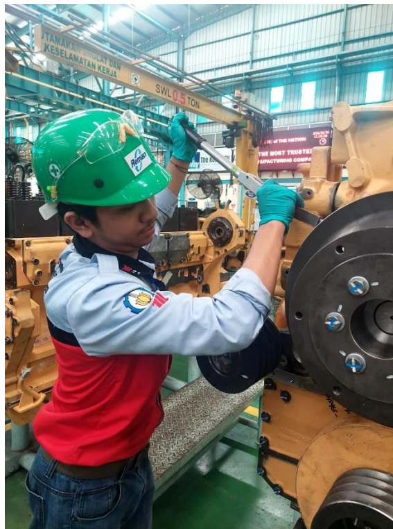
Pengencangan baut pada bagian bracket engine
