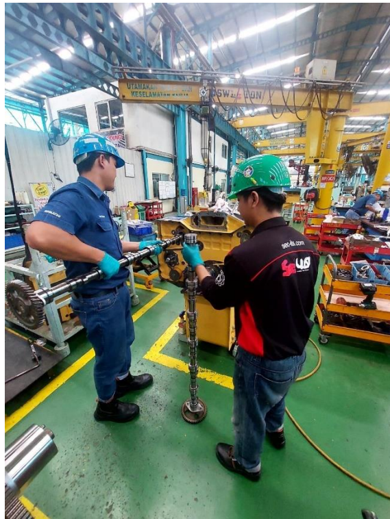
Pengukuran Endplay dan Backlash terhadap Timing Gear
