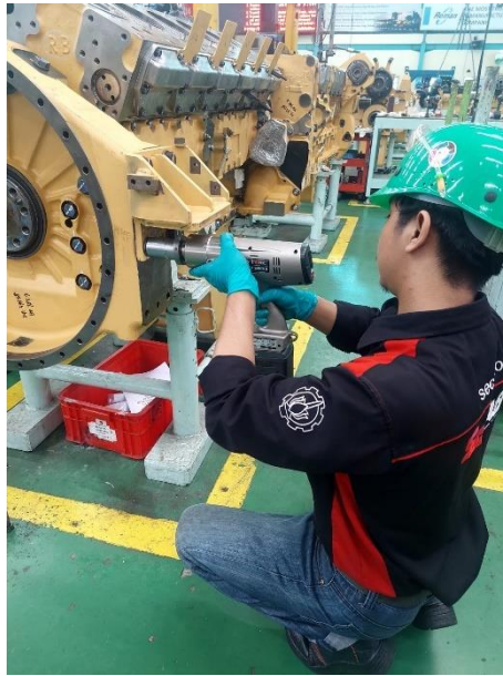
Pengencangan baut pada bagian bracket engine
