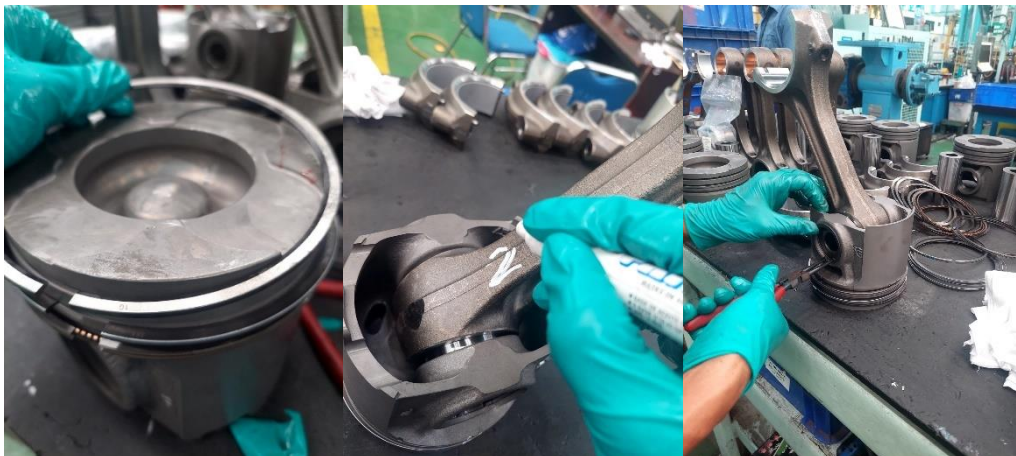
Pemasangan bagian part pada komponen piston
