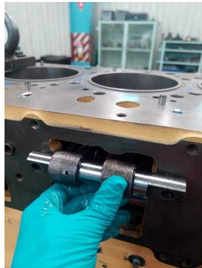
Pemasangan Camfollower kebagian camshaft
