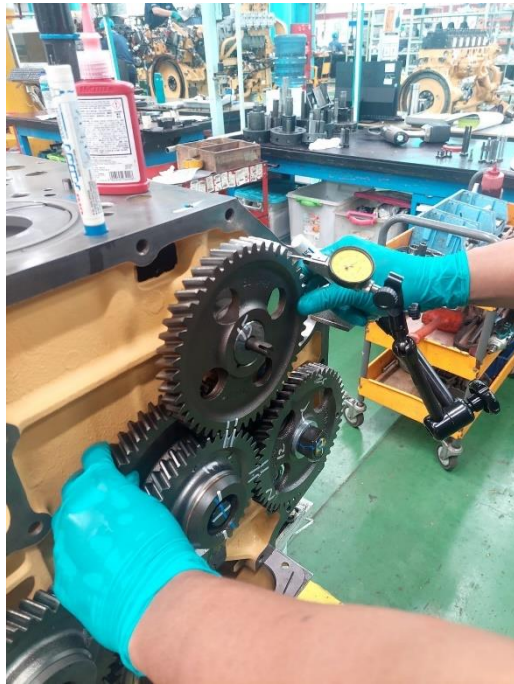
Pengukuran Endplay dan Backlash terhadap Timing Gear
