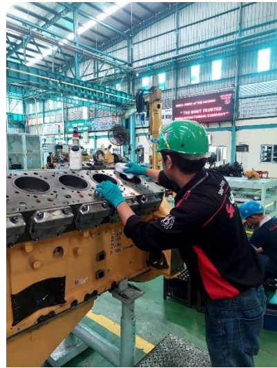
Pemasangan baut pada Cylinder head dan melakukan prepare sebelum melakukan pemasangan Clinder Head
