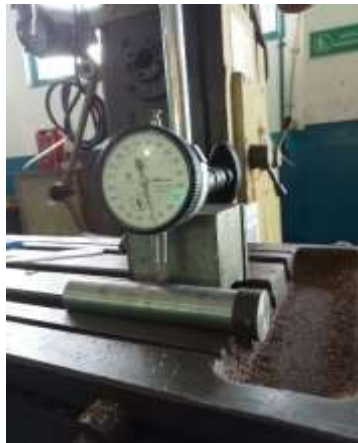
Gambar 4. 7 Proses pengukuran dengan dial (Sumber : Dokumen Pribadi)
