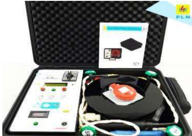
Gambar 2. 15 Portable change Over Switch (Sumber : Dokumentasi Pribadi)
