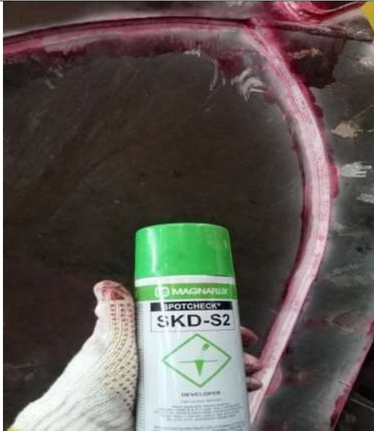
Pengujian Penetrant Test
