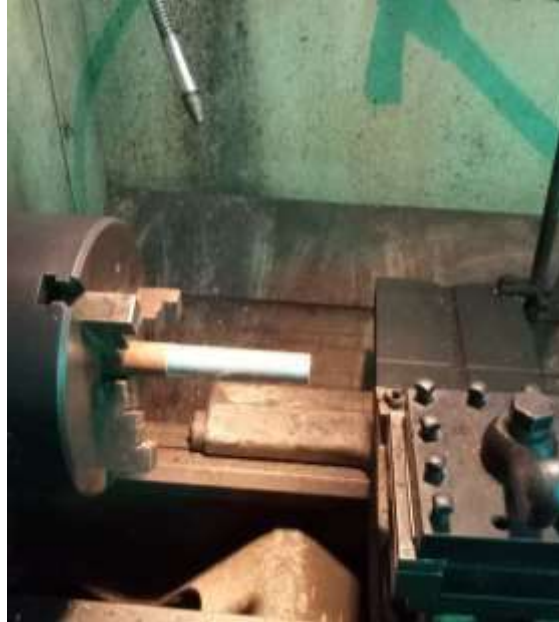
Gambar 4. 5 Proses Pembuatan benda kerja dengan mesin bubut di PT PLN PUSHARLIS Surabaya (Sumber : Dokumentasi Pribadi)
