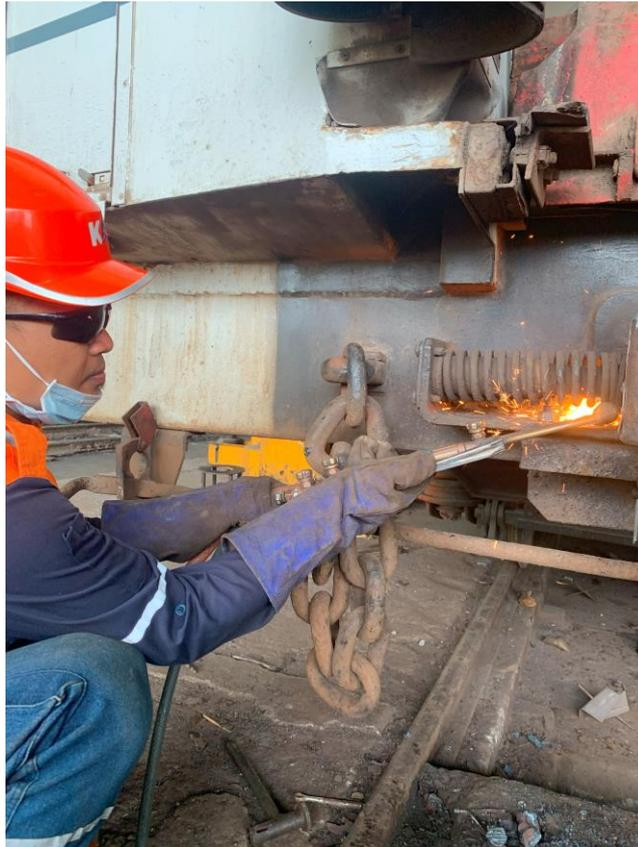
Pemotongan Sambungan Mur dan Baut Pada Mounting Coupler
