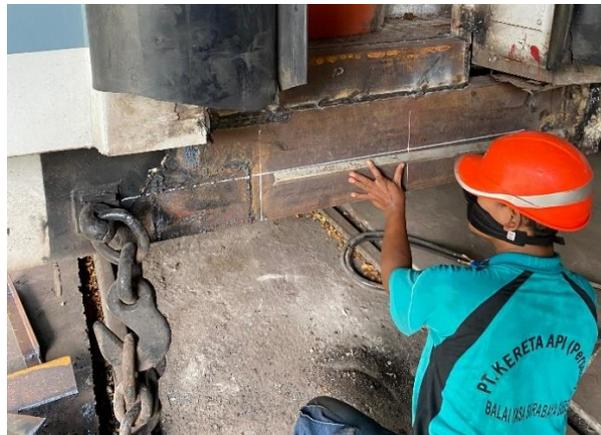
**Gambar 3.21** Mengukur Plat Untuk Lubang Coupler
