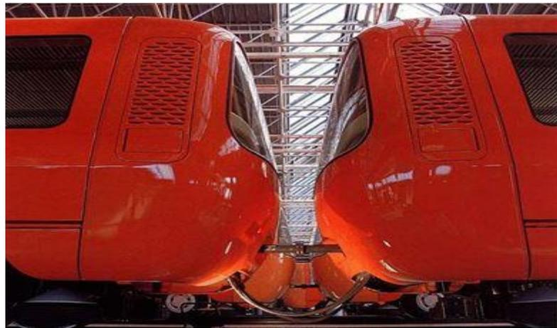
**Gambar 4.11** Penyambungan *Bar Coupler*
