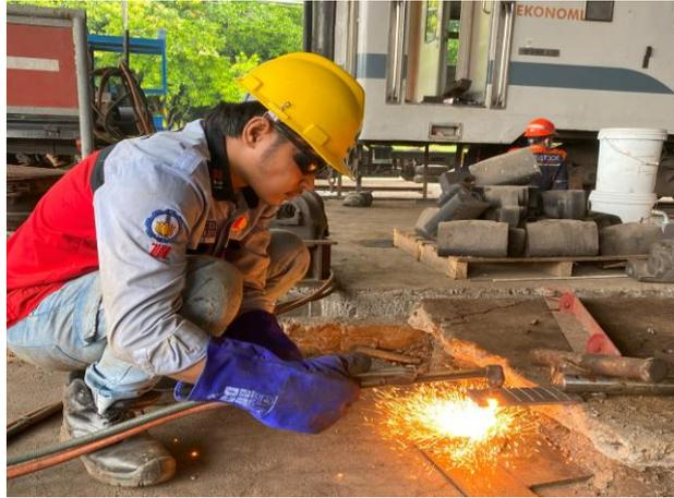
**Gambar 3.3** Praktek Menggunakan Alat *Acetylene Torch Cutter*
