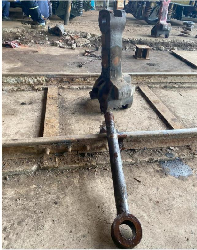
Coupler Dengan Sambungan Mur, Baut dan Pin
