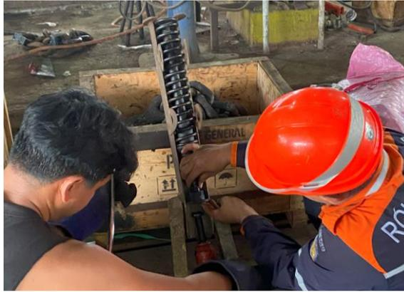
**Gambar 3.12** *Assembly Pegas untuk Tight Lock Coupler*
