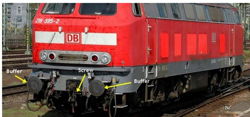
**Gambar 4.8** Bagian Utama dari *Screw Coupler*
