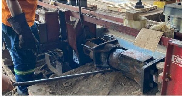
**Gambar 3.16** Alat *press* Untuk *Draft Gear* Tabung
