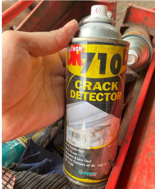
Cairan Crack Detector Untuk Metode NDT
