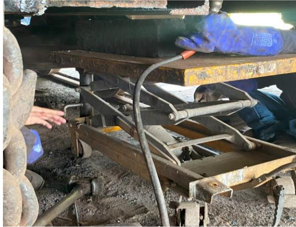
**Gambar 3.10** Mengeluarkan Draft Gear menggunakan meja Hidrolik
