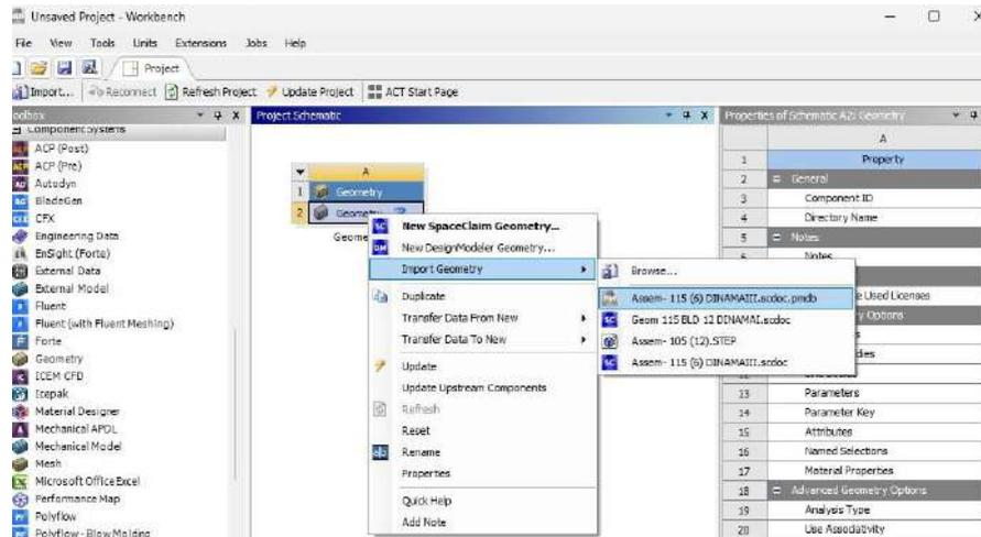
**Gambar 4.7** Tahapan *Import Geometry Impeller*
