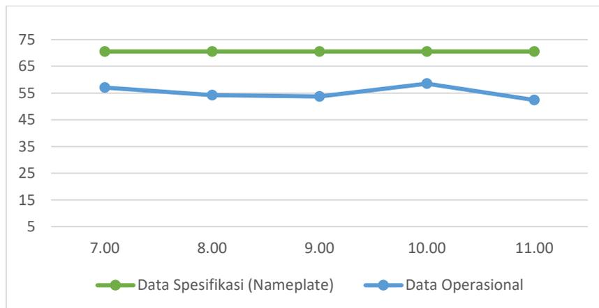
**Gambar 5. 16** Grafik efisiensi turbin berdasarkan data spesifikasi alat dan data operasional
