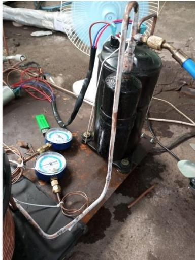
*Gambar 4. 4 Kompresor yang digunakan*
