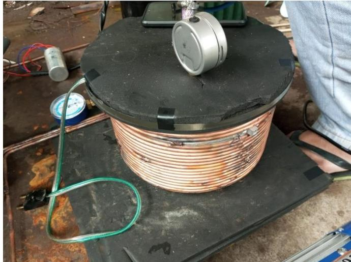
Gambar 4. 8 Evaporator yang Digunakan
