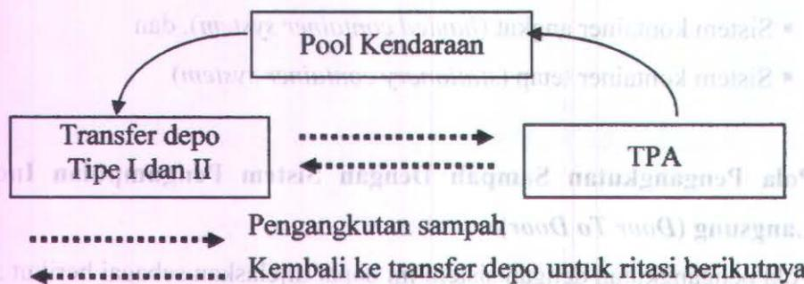
Gambar 2.2. Pola Pengangkutan Sistem Transfer Depo
