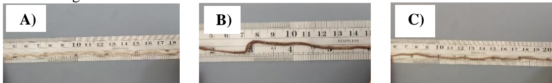
Gambar 4. 11 Hasil Filamen 3D printing dari campuran Hap dan PCl (A) 0,5:9,5 (B) 1:9 (C) 2:8
