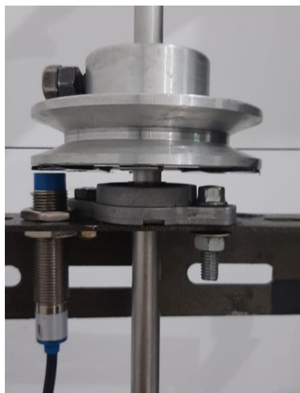
Gambar 3.15 Instalasi Sensor Proximity pada Pulley
