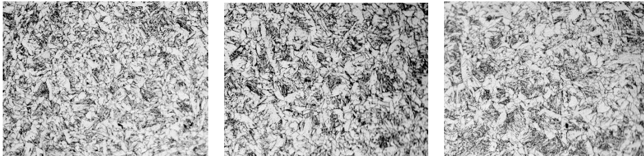
Gambar 4.40 Hasil pengujian mikro metalografi pada untuk spesimen dengan variasi 1,08 kJ/mm, 1,26 kJ/mm, dan 1,44 kJ/mm
