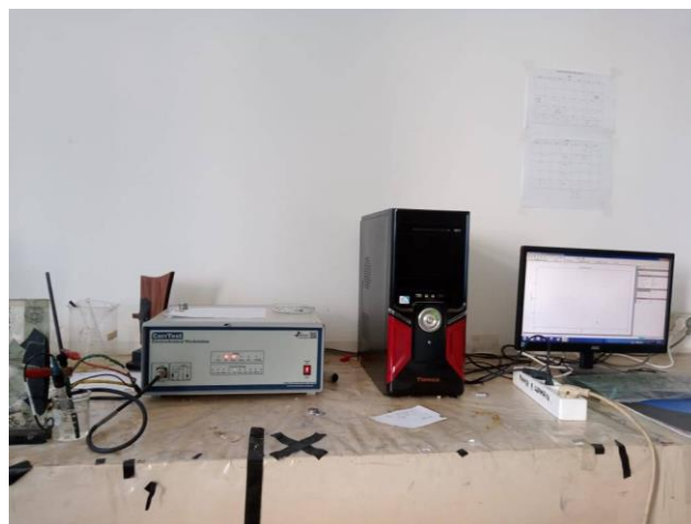
Gambar 3.11 Proses pengujian laju korosi
