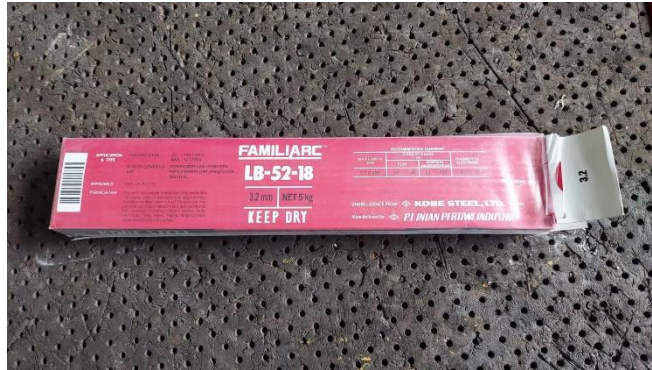
Gambar 3.4 Elektroda E7018 diameter 3.2 mm
