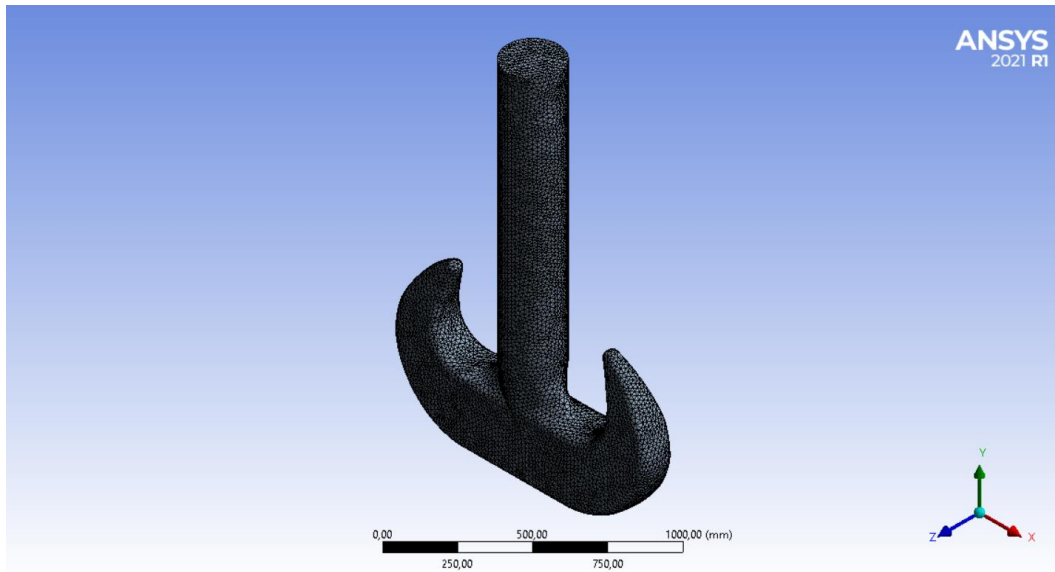
Gambar 4.32 Model Crane Hook Penampang Rectangular dengan Ukuran Mesh 16 mm.
