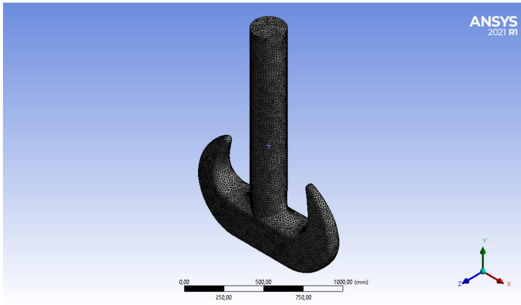
Gambar 4.27 Model Crane Hook Penampang Trapezoidal dengan Ukuran Mesh 16 mm.
