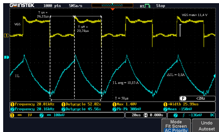
Gambar 4.10 Bentuk VGS dan Arus induktor ketika boost
