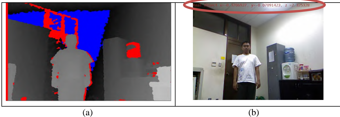
Gambar 4.10 Analisa kedalaman: (a) Citra kedalaman, (b) Citra kamera RGB
