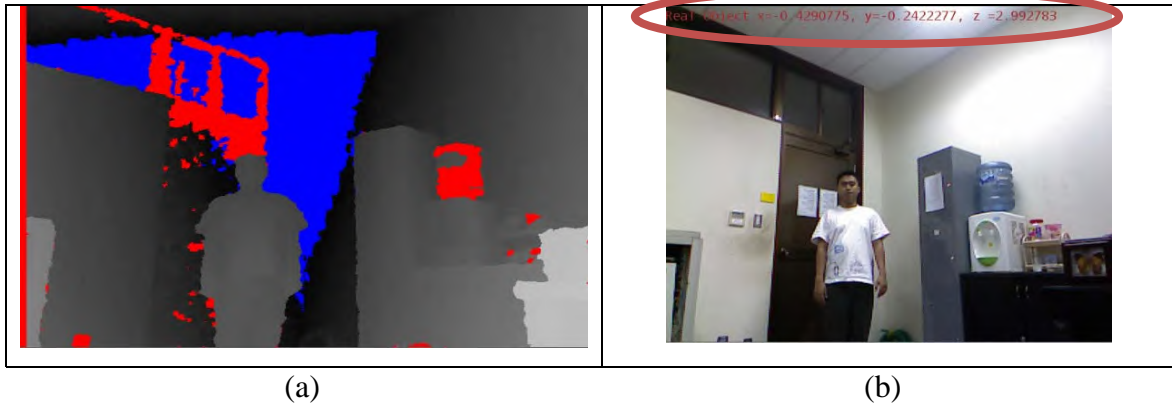
Gambar 4.9 Analisa kedalaman: (a) Citra kedalaman, (b) Citra kamera RGB
