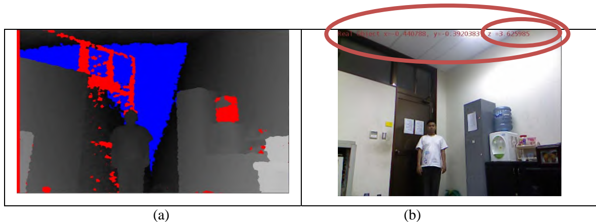
Gambar 4.2. Analisa kedalaman: (a) Citra kedalaman, (b) Citra kamera RGB
