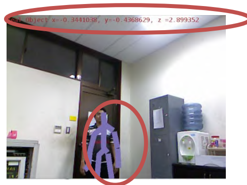
Gambar 4.8. Objek nyata 3D yang terdeteksi dan terlacak skeleton -nya
