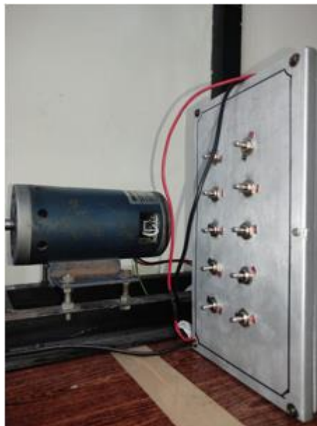
Gambar 3. 9 Generator DC dan beban resistor
