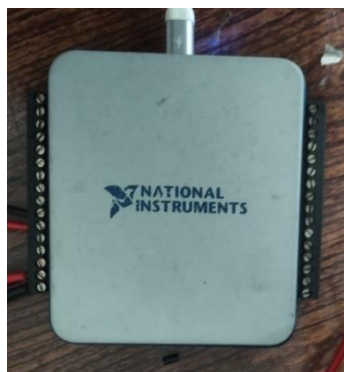
Gambar 3.3 DAQ NI USB-6001
