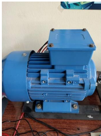
Gambar A.2 Motor Induksi Alliance A-Y3A
