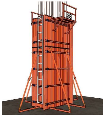
Gambar 4.12 Bekisting Kolom Dan Shear Wall Tampak Depan
