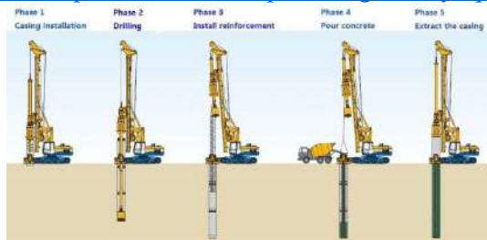
Gambar 4. 7 Alur Pekerjaan Borepile
