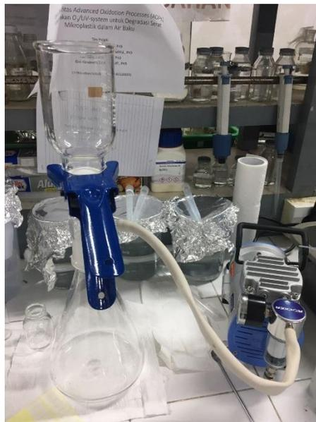
Gambar 3. 8 Perangkat Penyaringan Vakum
