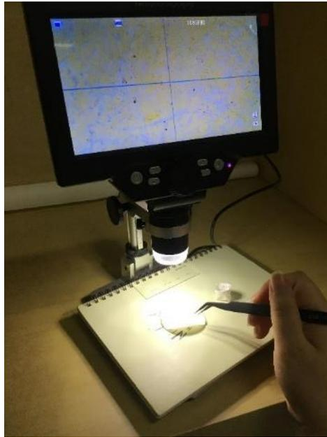
Gambar 3. 9 Pengamatan Mikroplastik di Bawah Mikroskop
