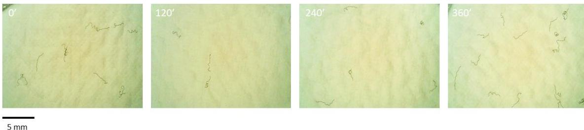
Gambar 4. 2 Hasil Pengamatan Mikroskop 0,1 mg/L PET dengan Intensitas Iradiasi  $30 \mu\text{W}/\text{cm}^2$
