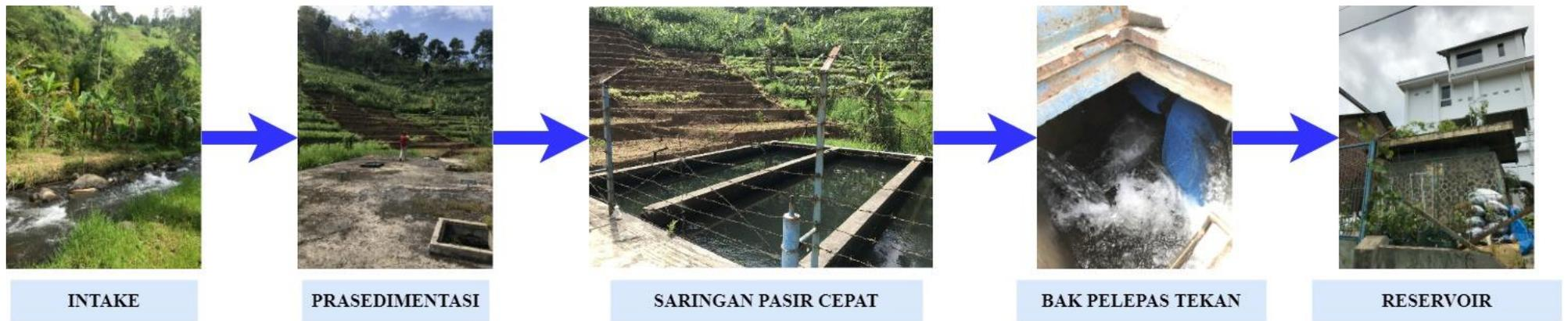
Gambar 2. 1 Bagan Alir Pengolahan Air Unit Produksi Pulung di IKK Pulung
