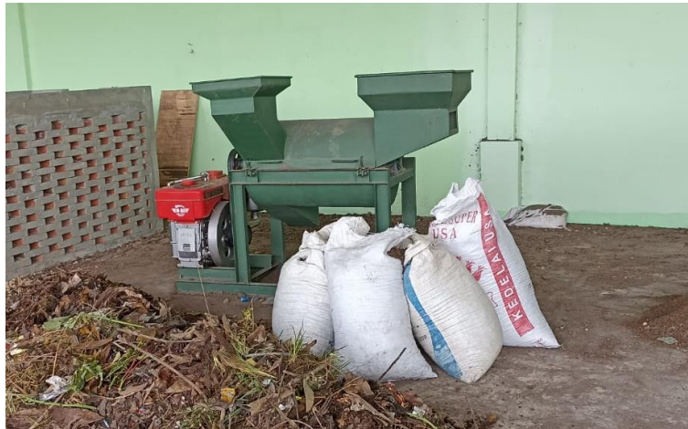
Gambar 4.8 Mesin pencacah sampah organik di TPS3R Lampung Padang
