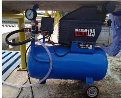
Gambar 3 7 Kompresor untuk Air Scouring
