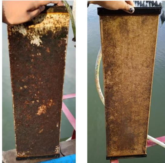
Gambar 4 13 Penampakan Membran Tanpa dan dengan *Air Scouring* 0,6 Bar
