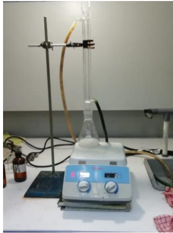
Gambar D.5 Proses Digestion Parameter TKN
