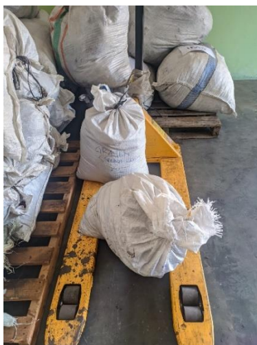
Gambar 4.32 Kemasan Limbah B3 Tanpa Alas Pallet
