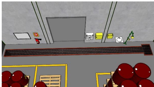
Gambar I.7 Saluran Drainase dan Bak Penampung
