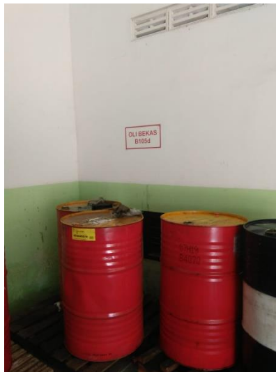
Gambar 4.33 Peletakan Drum Dalam Satu Pallet yang Tidak Sesuai
