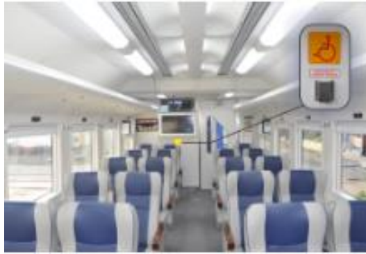
Gambar B.9 Interior Kelas Eksekutif Dilengkapi Fasilitas untuk Difabel
