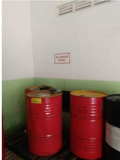
Gambar 2.19 Tidak Ada Pemberian Simbol dan Label Pada Kemasan Limbah
