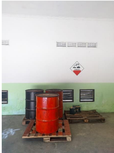
Gambar 4.23 Kemasan Debu/Pasir Ex-Blasting Belum Terdapat Simbol dan Label
