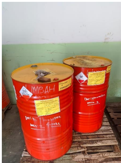
Gambar 4.30 Peletakan Simbol dan Label Tidak Sesuai Peraturan
