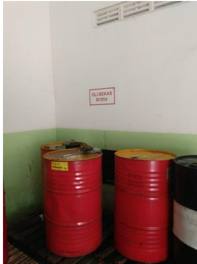
Gambar 4.29 Tidak Ada Pemberian Simbol dan Label Limbah B3 serta Label Penunjuk Tutup Pada Kemasan Limbah B3 Penuh
