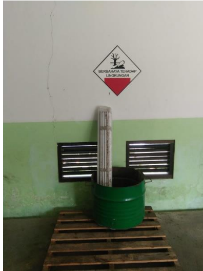
Gambar 4.27 Kemasan Limbah Lampu TL Yang Kurang Tepat
