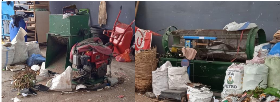
Gambar 2. 6 Mesin Pencacah dan Pengayak Kompos
