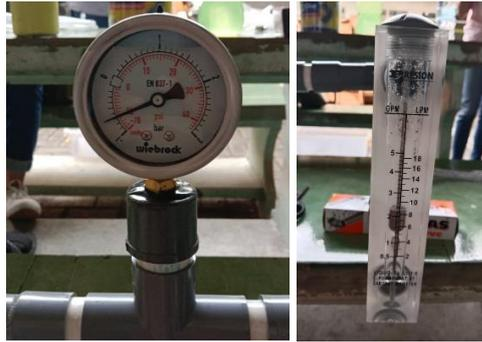
Gambar 3.5 Pengecekan Tekanan dan Debit Membran
