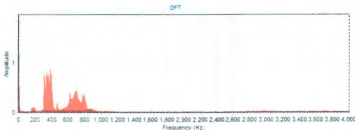
Gambar 4.48 Frekuensi Hasil DFT Sinyal Pengucapan Vokal U
