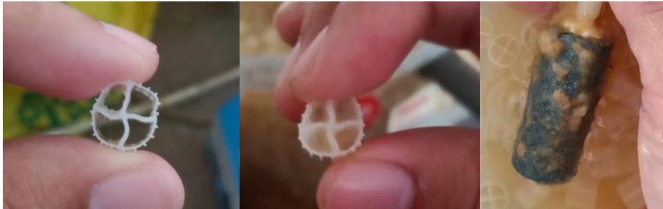
Gambar 4. 1 Kondisi Media Kaldness Awal (Kiri), Media Kaldness yang Telah mengalami Penebalan Biofilm (Tengah), dan Kondisi Diffuser Aerator yang Terselimuti Biofilm (Kanan)
